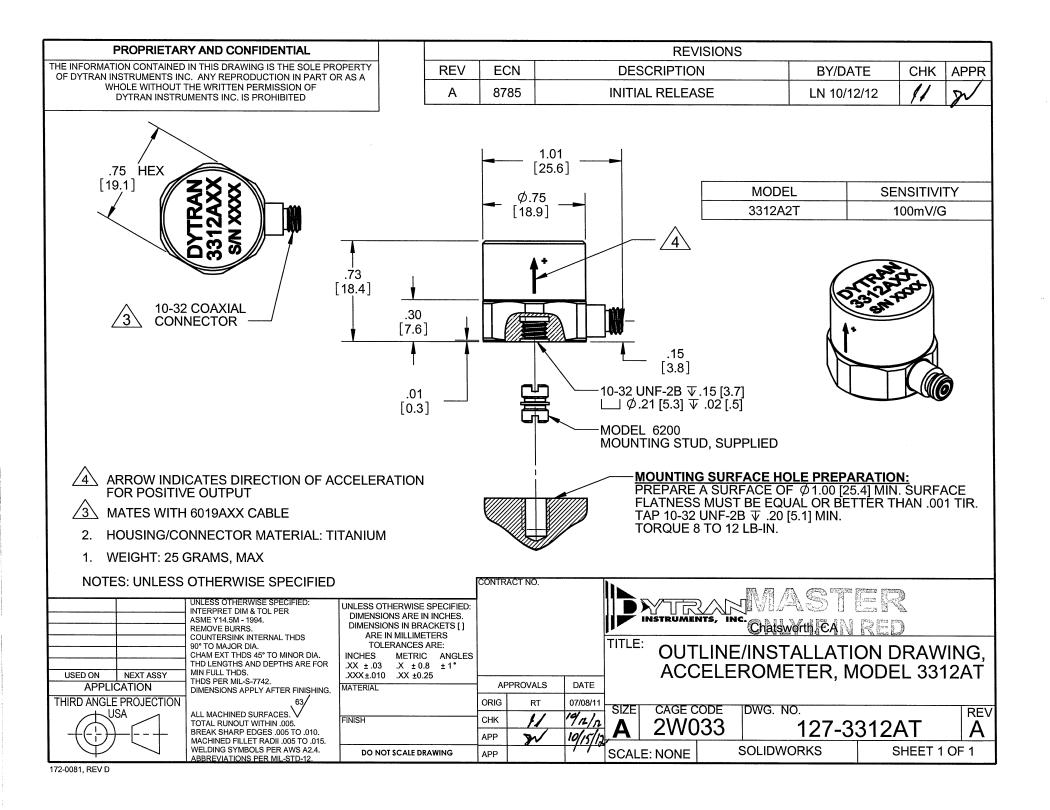
Model Number DOC NO PERFORMANCE SPECIFICATIONS 3312A2T PS3312A2T IEPE ACCELEROMETER REV A, ECN 8785, 10/12/12
