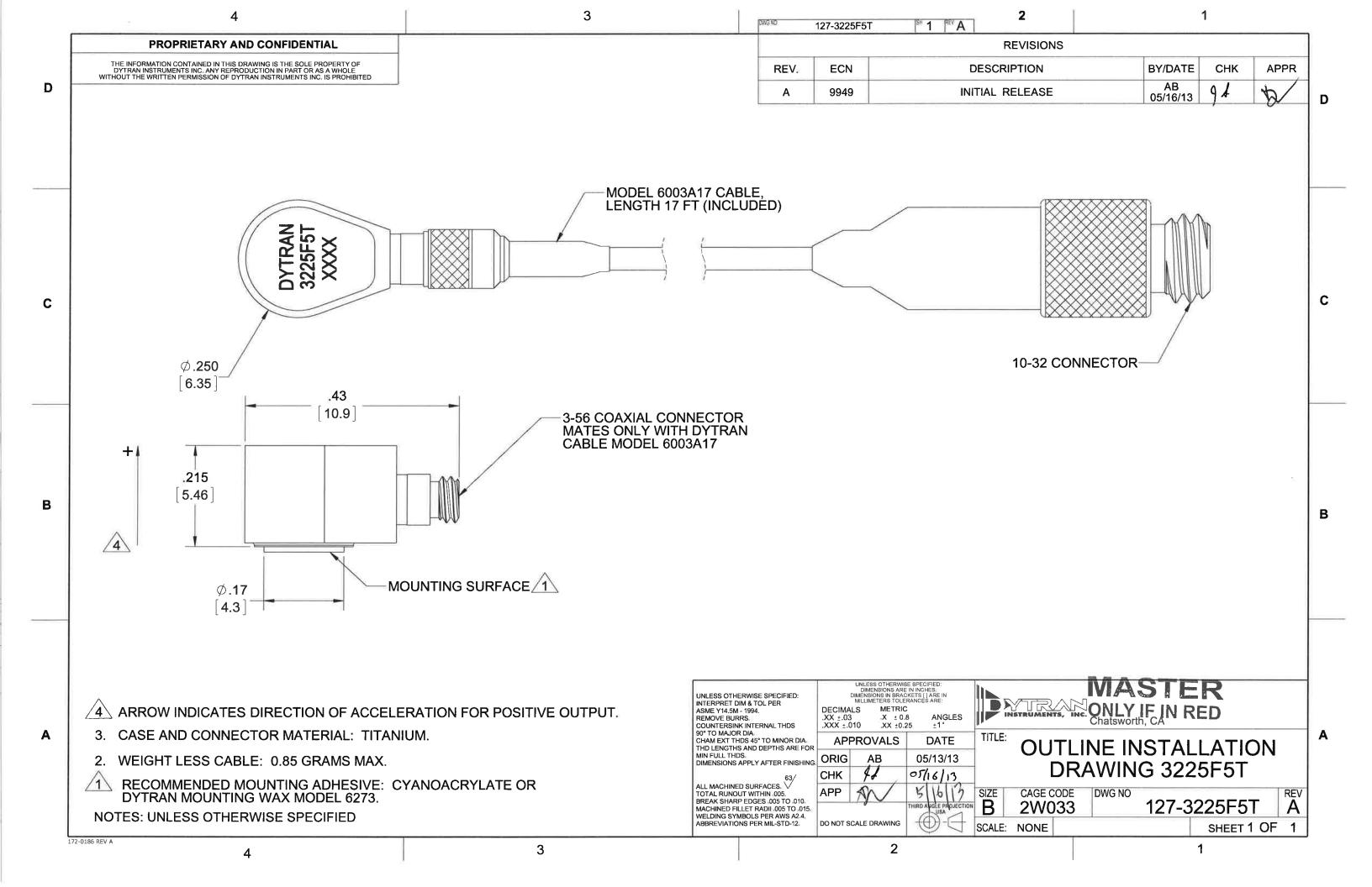
**MODEL NUMBER** DOC NO. PERFORMANCE SPECIFICATION 3225F5T PS3225F5T ACCELEROMETER, IEPE REV D, ECN 13008, 10/26/16
