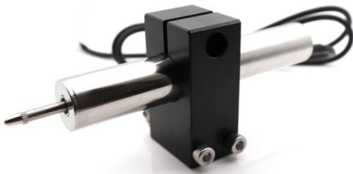
1. LVDT传感器定位安装要求采用温度膨胀系数小的非金属材质进行固定,如采用金属块安装会对产品性能产生影响;
